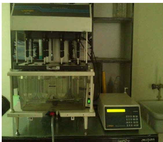
Fig 3.5: Dissolution Tester (LABINDIA DS 8000, India)
