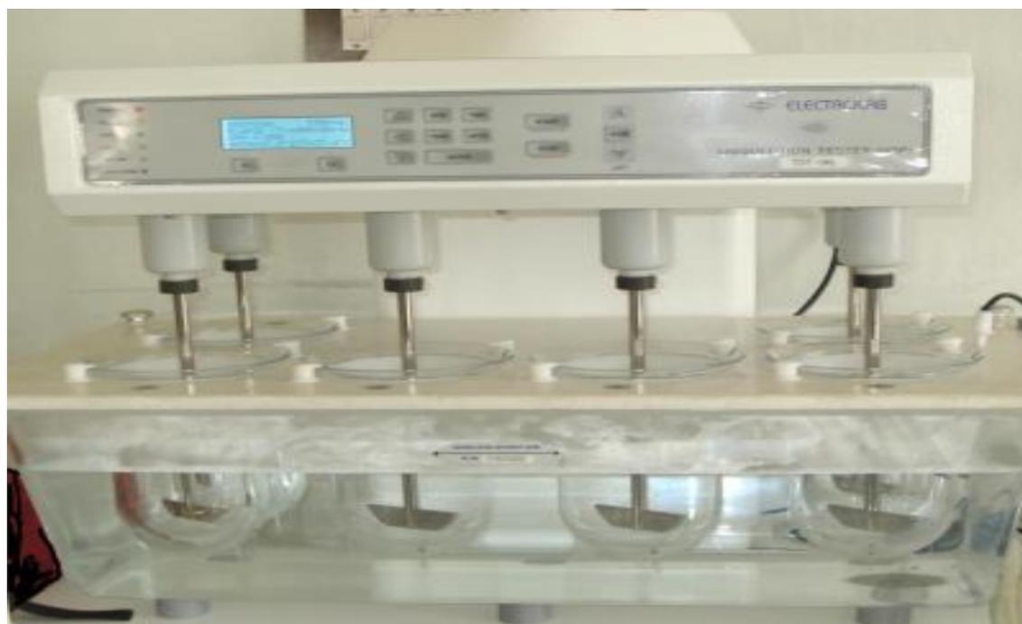
*Figure : USP XIII Tablet Dissolution Apparatus II*
